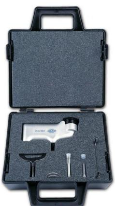
GYZJ 934-1 알루미늄이나 알루미늄합금, 구리,황동, 플라스틱, 섬유 유리와 같은 재료에 적합하다. 측정범위는 약 25~ 150브리넬 (10 mm 볼 500 kg 하중). 본 유닛은 (ASTM) 표준 D2583에 최적입니다.
